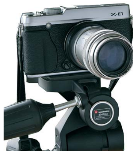
Lo Steiner Culminar 85mm montato sulla Fuji X-E1. Per il fattore di moltiplicazione 1,5x l'obiettivo diventa quasi un 135mm e focheggiare a mano libera sul display o attraverso il mirino non è impresa semplice: l'uso del treppiedi è quindi raccomandato.
