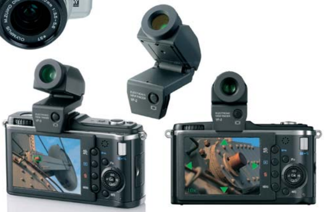
Una focale 50mm su una digitale Micro Quattro Terzi è equivalente a 100mm: è quindi necessaria una attenta messa a fuoco del soggetto. A nostra esperienza focheggiare sul display non è semplice (a meno che la fotocamera non sia su treppiedi), per cui conviene dotarsi di un mirino elettronico opzionale (se non è incorporato).
